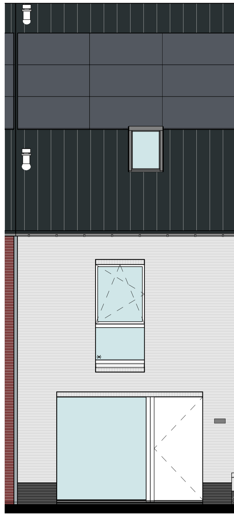
Optie 1.8.12 Dakraam 780x1400mm Aanzicht voorgevel
